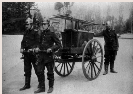
Bomba MTM 1875. Adquisición de 1875. Bomba manual de incendios fabricada por la Maquinista Terrestre y Marítima a partir de un modelo francés. Para aspirar agua directamente de una balsa o canal. Tiene un depósito que se puede llenar con cubos de agua. ABB
