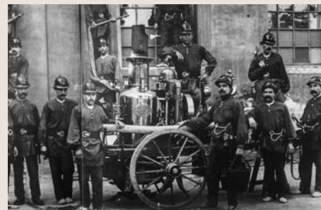
Merryweather Valiant II 1896. Adquisición de 1896. Fabricación inglesa. Bomba de incendios de vapor ligera con caudal de 900 l/m. Se necesitaban un mínimo de dos bomberos para desplazarla. ABB
