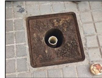
Instal·lació i lectura de fita d'anivellació de terreny en superfície
