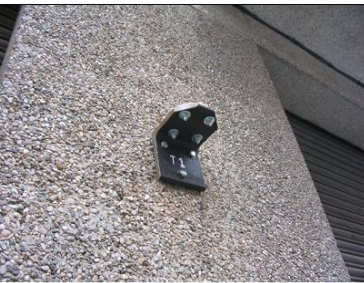
Instal·lació de clinòmetre en façana
