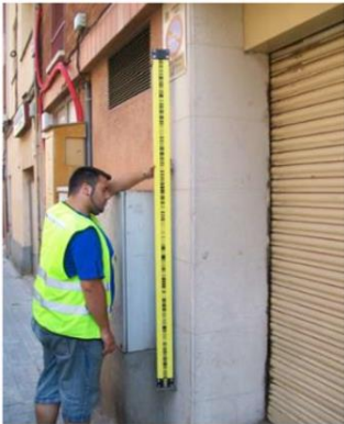
Instal·lació i lectura perns d'anivellació en façana
